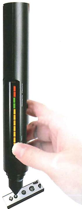
图 37 被测宝石为莫桑石时，钻石、莫桑石一体热导检测仪的状态
