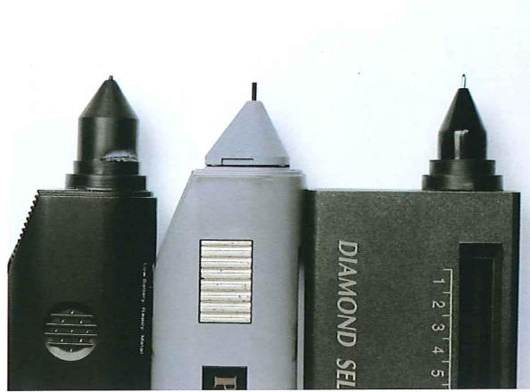
图 27 钻石热导仪、莫桑石检测仪测试端（左为钻石、莫桑石一体热导检测仪，中为莫桑石检测仪，右为钻石热导仪）
