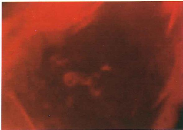
图 94 玻璃充填处理红宝石阴极发光图
