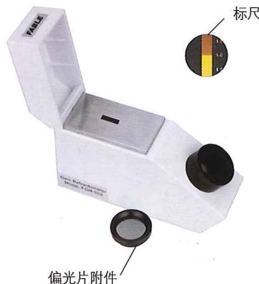
图 1 折射仪外观、偏光片附件、通过目镜看到的标尺
