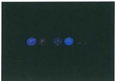
图 17 LW 紫外光下钻石的荧光
