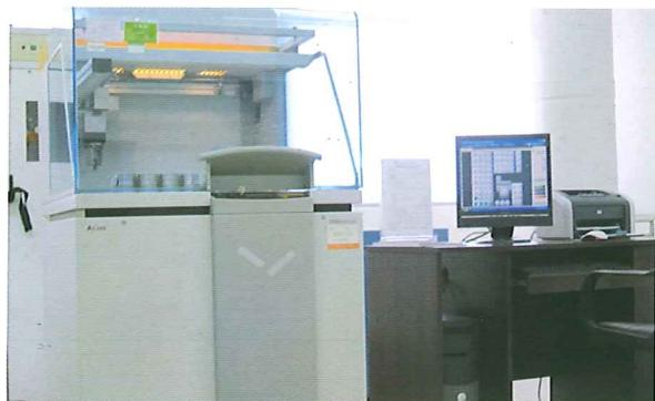
图 51 波长色散型 X 荧光光谱仪
