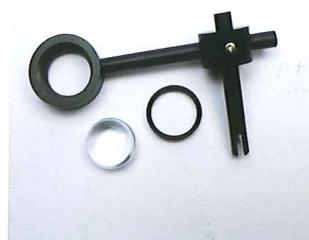
图 46 锥光干涉球外观及结构图
