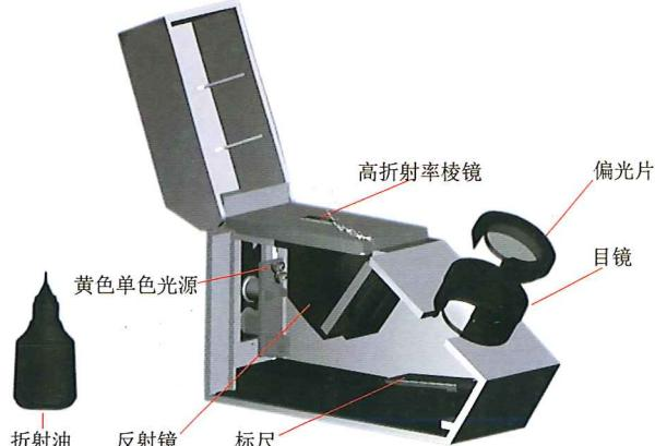
图 5 折射仪内部结构名称实物示意图
