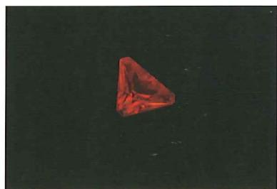
图 9 SW 紫外光下人造钇铝榴石的荧光
