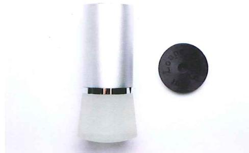
图17 左边切工镜，右边为切工镜附件(特制黑色宝石托盘)
