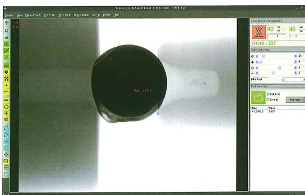
图 102 X 射线珍珠层厚度测试仪软件测量珠层厚度
