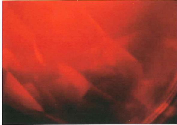
图 97 水热法合成红宝石阴极发光图
