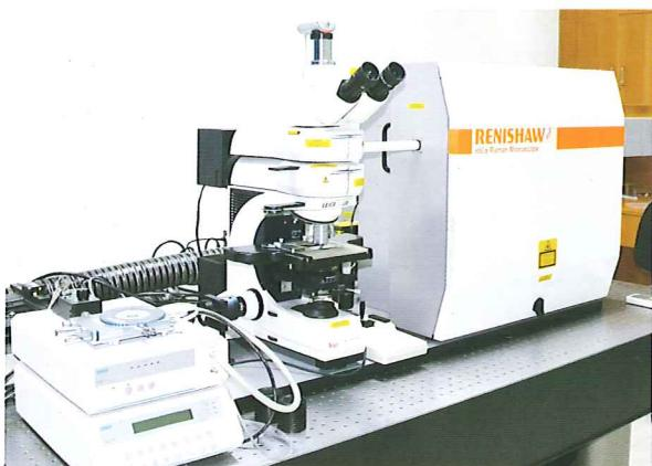
图 19 激光拉曼光谱仪外观图
