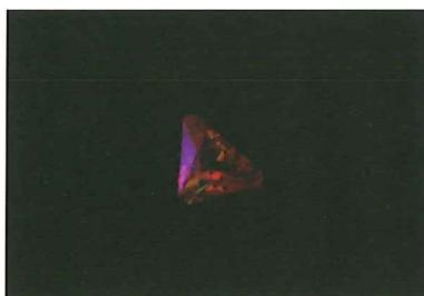
图 8 LW 紫外光下人造钇铝榴石的荧光
