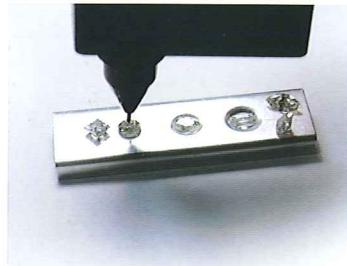
图 34 探针垂直地与被测真、仿钻石的台面轻轻地接触
