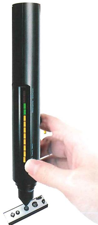
图 38 被测宝石为钻石时，钻石、莫桑石一体热导检测仪的状态
