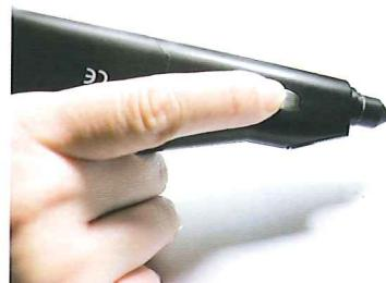
图 33 手持仪器时右手食指触及仪器后盖的导电板
