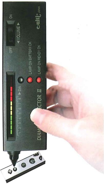
图 35 被测宝石为钻石时，钻石热导仪的状态
