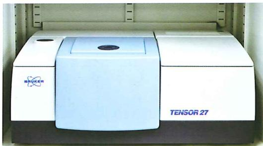
图3 傅里叶变换红外光谱仪
