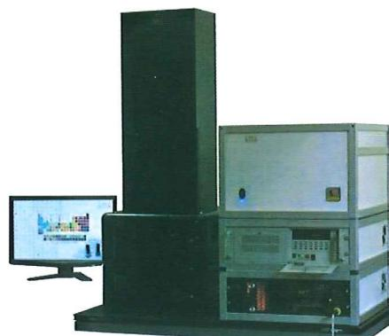
图 69 激光诱导击穿光纤光谱仪 (LIBS)
