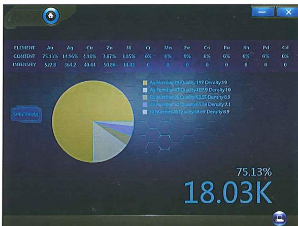
图 57 能量色散型 X 荧光光谱仪分析贵金属首饰含量数据
