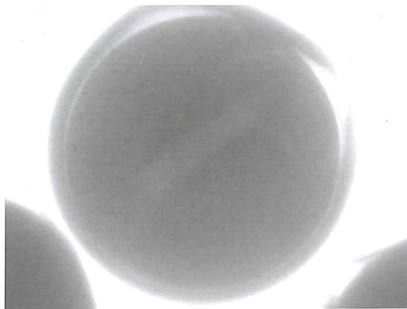
图 100 X 射线珍珠层厚度测试仪测试海水珠有核结构
