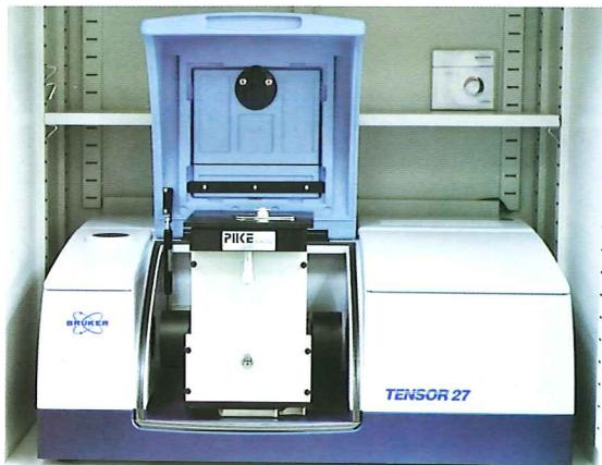
图9 红外光谱反射法测试宝石示意图
