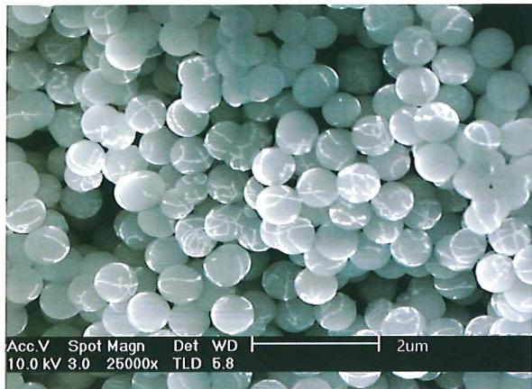
图 66 不同淡水珍珠表面及内部自然断面扫描电镜下的形貌特征
