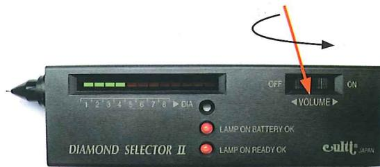
旋转图中蓝色尖头所指旋钮，调整绿灯数量为实际温度条件及宝石大小结合热导仪背后表格中的数字，例如 10~30°C，宝石重量在 0.06~0.5ct 选择数字 4，绿灯数量调节为 4。
